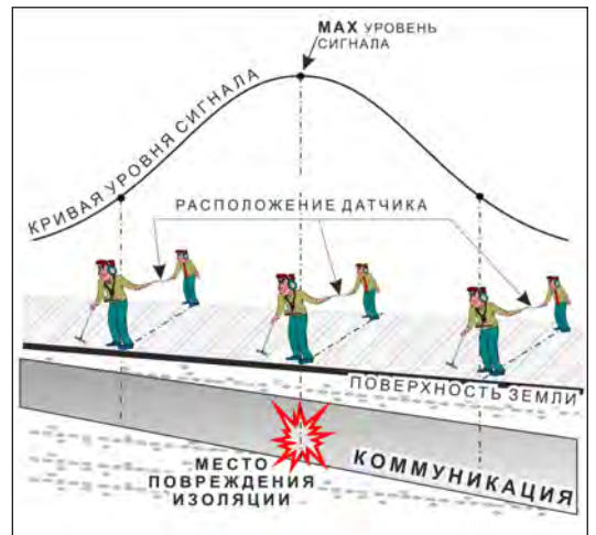
применение датчика-определителя дефектов коммуникации (ДОДК) методом max
