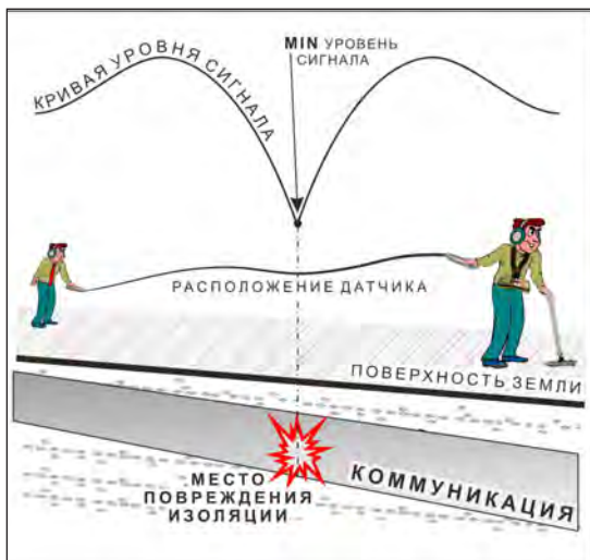
применение датчика-определителя дефектов коммуникации (ДОДК) методом min
